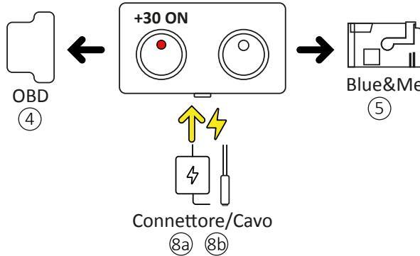
**FIG.2** È anche possibile utilizzare la presa OBD (4) come unica sorgente di alimentazione
